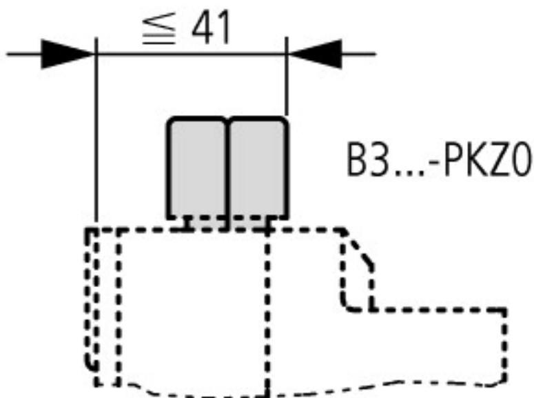
Überlappende Montage zur Verlängerung des Stromschienenblocks
