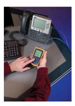
unabhängig vom Einsatzumfeld exakt orten lassen. Im digitalen Modus können hochwertige Datenkabel (Cat 5e, 6, 6a) in Kabelbündeln oder an Switches, Patchfeldern oder Wanddosen gefunden werden. Der Analogmodus eignet sich für Sprachkabel (Cat 3 und darunter) sowie für Koaxial-, Sicherheits-/Alarm- und Lautsprecherkabel.
