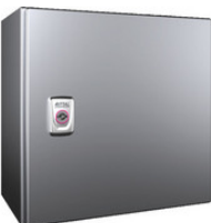
1003000 Kompakt-Schaltschrank AX, Edelstahl 1.4301, 1-türig, BHT 300x300x210 mm
